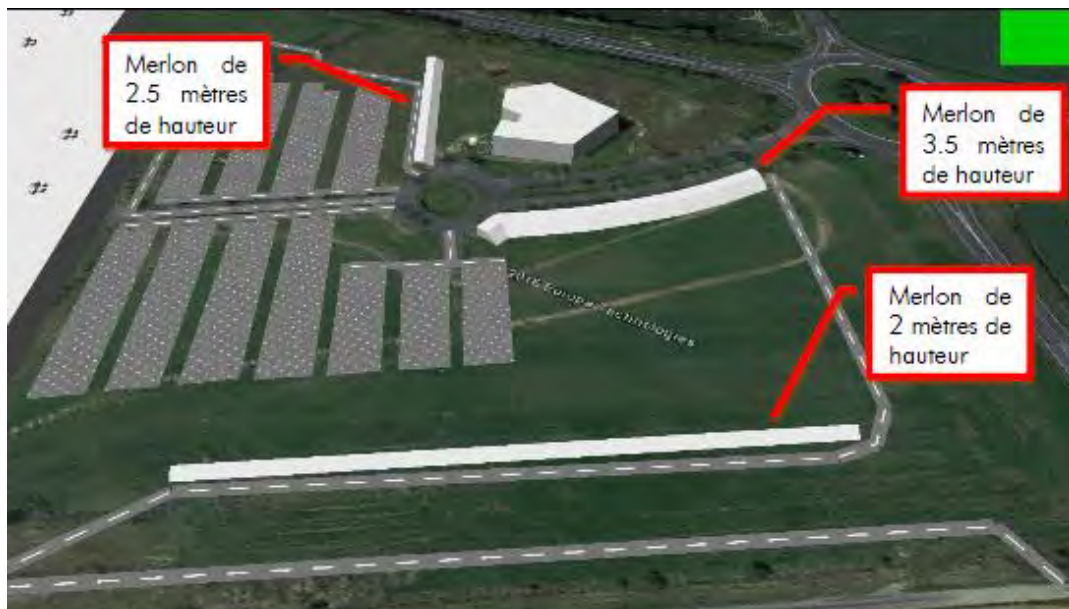
Figure 27 : Disposition des merlons sur le site
